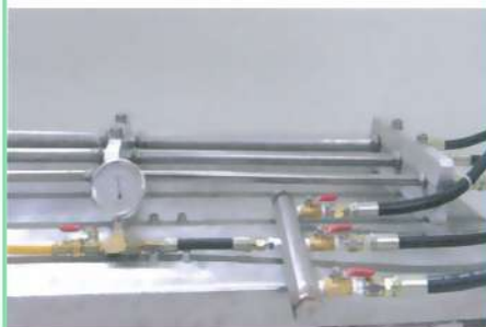
擺動水壓試驗(水壓加至25kgf/cm 2 )
